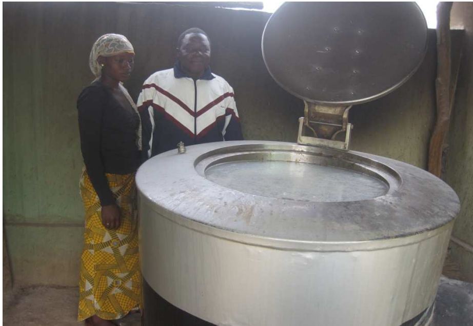
Mini-laiterie de Kayes, utilisant des pasteurisateurs en bois en raison de son non branchement au réseau d'électricité.
